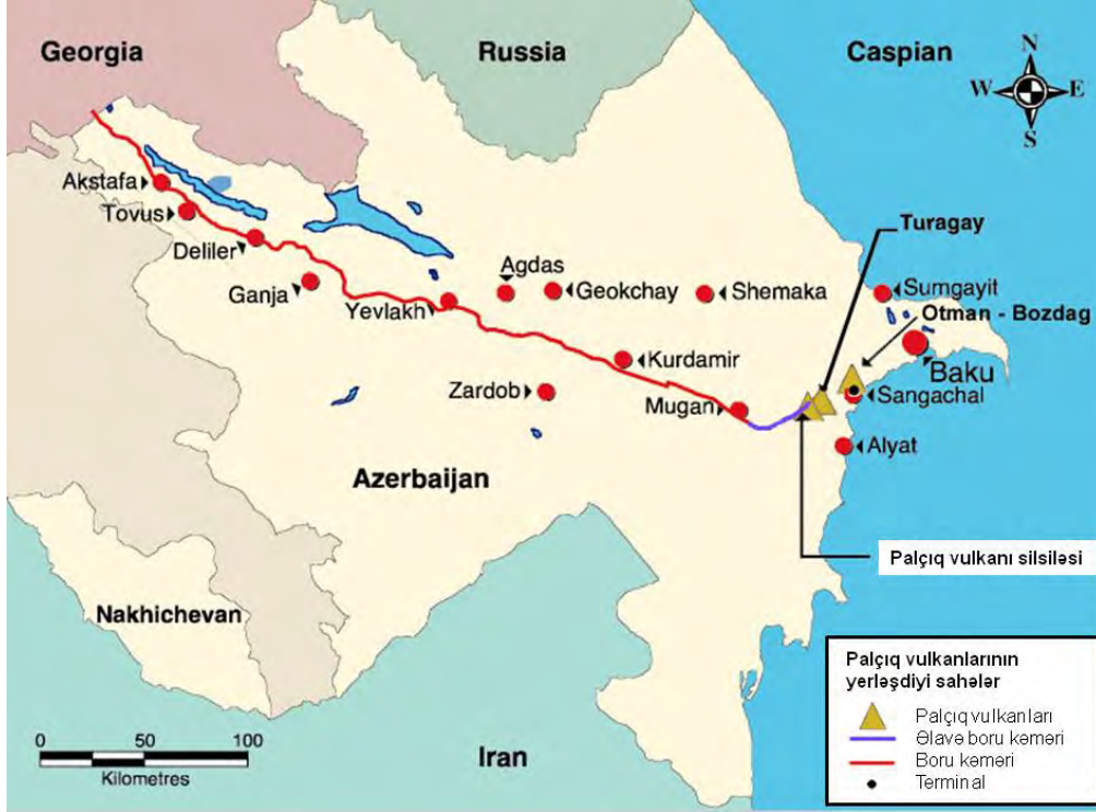
Şəkil 7-4: CQBK/CQBKG boru kəməri marşrutu boyu palçıq vulkanlarının yerləşdiyi sahələr (Mənbə: RSK, 2002)
